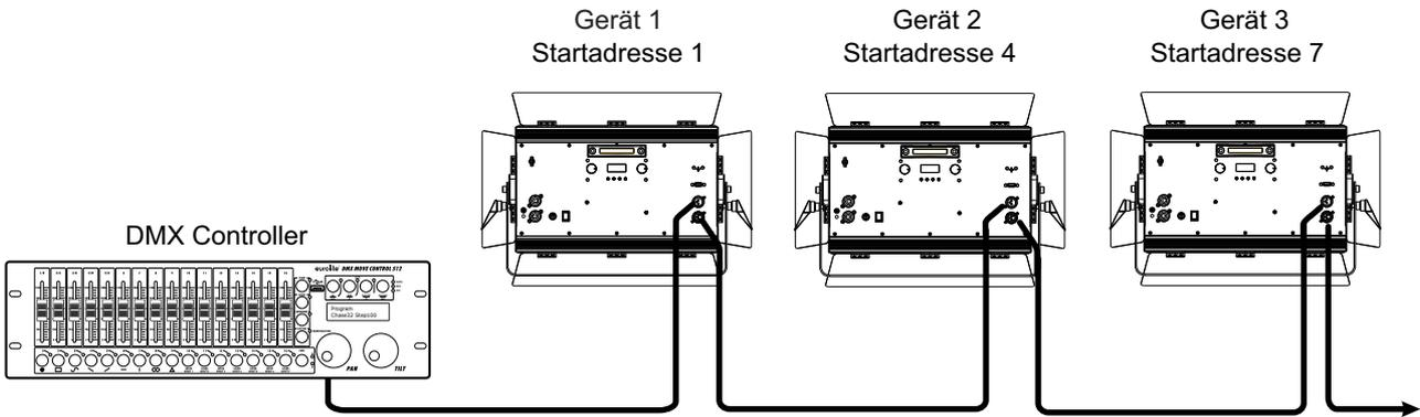
Für die Ansteuerung des Geräts per DMX512 ist eine Datenverbindung notwendig. Das Gerät verfügt dazu über 3-polige XLR-Anschlüsse.
