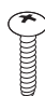
Vijaki za stojalo 8EA, M4 x 20 (glejte stran A-3, A-4, A-5, A-6)
